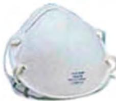
Sl. 42. Zaštita organa za disanje respiratorom sa filter poluobrazinom za zaštitu organa za disanje od neotrovne prašine. Ne štiti od sitne prašine i plinova.
