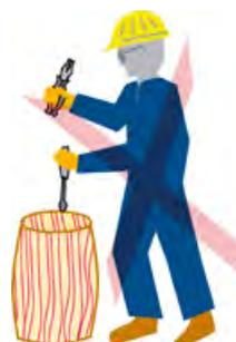
Sl. 17. Pri korištenju ručnog alata nisu dozvoljene improvizacije, npr. korištenje kliješta umjesto čekića i sl. Za svaki posao treba upotrijebiti odgovarajući i ispravni alat. Oštricu ili vrh alata ne usmjeravati prema tijelu. Radno odijelo rukovaoca alata treba biti zakopčano i stegnuto uz tijelo, a ne smije se nositi bilo kakav drugi dio odjeće koji može doći u zahvat alata.
