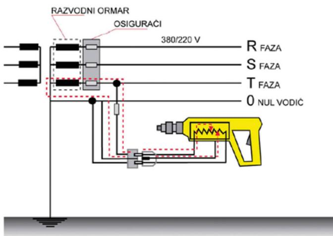
SI. 4. Prikazan je ručni alat na električnu energiju nazivnog napona izmjenične struje od 220 V trošilo klase I sa zaštitnim vodičem, kod kojeg je metalno kućište spojeno na zaštitni vodič (nulovano) preko utikača i utičnice sa zaštitnim kontaktom (trošilo I klase). Zabranjeno je "krpati" uloške osigurača žicom ili postaviti osigurače većih nazivnih struja.
