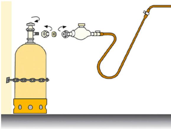
Sl. 10. Bocene s tehničkim komprimiranim plinom, postavljaju se u okomiti položaj uz obvezatno učvršćivanje lancem ili užetom uz zid ili sa posebnim nosačem. Za boce s komprimiranim kisikom je bitno da ventili ne smiju nikada biti masni. Boce s acetilonom treba uvijek držati uspravno ili polegnute do najviše 45°.
