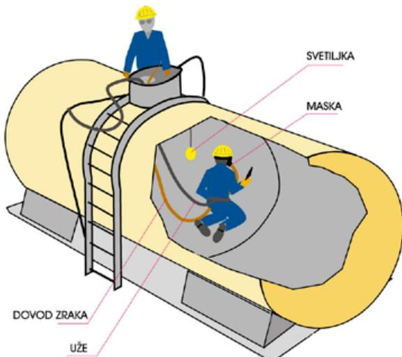
Sl. 30. Pri radu u zatvorenim, vlažnim i metalnim (električki provodljivim) spremnicima, potrebno je prije ulaska prozračiti prostor i izmjeriti koncentraciju plinova i kisika. Koristiti po potrebi izolacioni aparat s dovodom zraka ili s bocama, vezati se sigurnosnim
