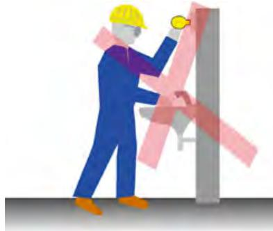
SI. 8. Istovremeni dodir tijela pod naponom i npr. vodovodne metalne cijevi, stvara se opasnost strujnog udara. Pri zamjeni žarulje svih vrsti svjetiljki ili otvaranje električnih uređaja, treba najprije isključiti napon.
