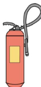
Sl. 55. Aparat pod stalnim tlakom za početno gašenje požara prahom. Dijelovi aparata jesu spremnik, ručica za aktiviranje, osigurač, crijevo i mlaznica te često manometar. Na aparatu se mora nalaziti naljepnica s rokom uporabe. Najmanje jednom godišnje aparat provjerava ovlaštena pravna osoba. Spremnik je pod stalnim tlakom od cca 15 bara.
