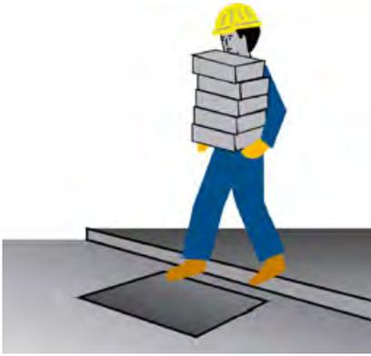
Sl. 27. Pad u otvor na podu uslijed zaklonjenosti vidika teretom. Svi otvori na podu moraju se ograditi i označiti. Putovi i prolazi, stepenice i sl. predviđeni za kretanje, moraju biti bez zapreka i dobro osvijetljeni. Bez dozvole rukovodioca radnici ne smiju prelaziti u odjele u kojima nemaju posla.
