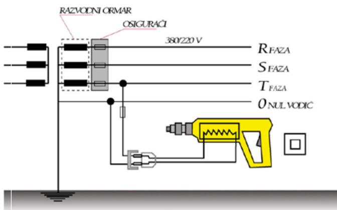
SI. 5. Ručni električni alat priključen na napon izmjenične struje od 220 V kod kojeg ne postoji zaštitni vodič jer je kućište izolirano i nevodljivo (npr. plastika) tzv. trošilo klase II sa zaštitnom izolacijom.
