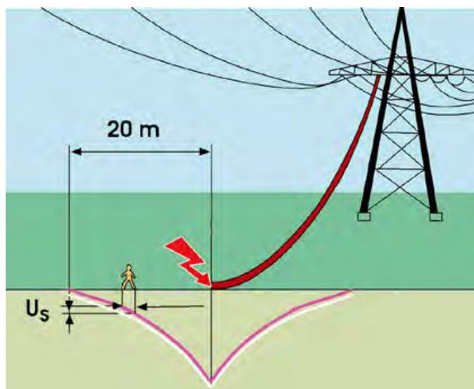
SI. 9. Opasno je približiti se na manju udaljenost od 20 m od mjesta na kojem struja visokog napona teče u zemlju. Ne smije se dodirivati vodiče vodova koji su pali na zemlju jer mogu biti pod naponom.
