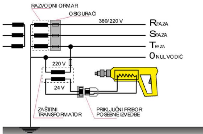
SI. 6. Ručni električni alat priključen na maleni sigurnosni napon od 24 V izmjenične struje tzv. trošilo klase III.
