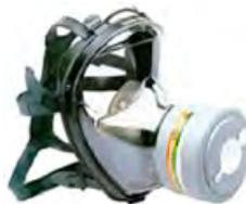
Sl. 41. Zaštita organa za disanje plinskom maskom sa obrazinom za zaštitu od štetnih plinova, para i aerosola (dim, magla i prašina) uz uvjete: za minimalno 16% kisika u atmosferi i kada je poznata vrsta i koncentracija štetnih plinova. Kod manje od 16% kisika u atmosferi, koristi se maska s dovodom zraka ili izolacijski aparat.
