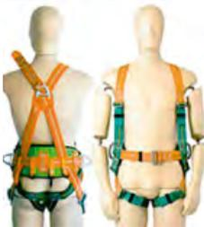
Sl. 46. Zaštita od pada s visine ili u dubinu - pojas za pričvršćenje s alkama za prihvat prednjeg sigurnosnog užeta. Izrađuje se prema normi (HRN EN 361). Ne smije se zamijeniti sa sigurnosnim pojansom za pridržavanje.
