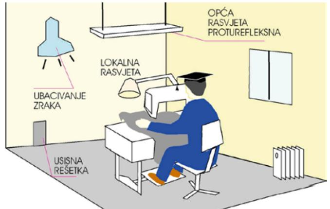
Sl. 31. Radna prostorija mora biti prostrana, dobro osvijetljena, grijana i ventilirana. Po osobi je potrebno osigurati površinu od barem 2 m<sup>2</sup> poda te 10 m<sup>3</sup> zračnog prostora. U radnim prostorijama se zaviso od vrste radova preporučaju sljedeći mikroklimatski uvjeti: 1. rad bez fizičkog naprezanja 20–24 °C; 2. laki fizički rad 18 – 20 °C; 3. teški fizički rad 12–18 °C; relativna vlažnost od 40 do 60%.
