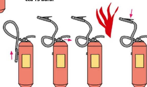
Sl. 56. Postupak aktiviranja aparata za početno gašenje požara: 1. donjeti aparat na prihvatljivu udaljenost od požara, uhvatiti mlaznicu, 2. izvući osigurač, 3. usmjeriti mlaznicu prema požaru, 4. pritisnuti ručicu na aparatu i ručicu na mlaznici na crijevu (ukoliko je izvedena)
