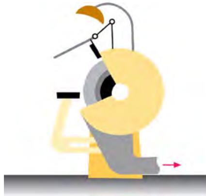
brusilice opremljene zaštitnim napravama, staklenom zaštitom za oči radnika te ventilacijskim sustavom sa usisavanjem zraka. Dok se stroj nalazi u pogonu nije dozvoljeno njegovo podešavanje, podmazivanje, čišćenje i popravljanje.
