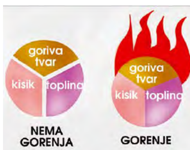
Sl. 29. Tri uvjeta nastanka požara: goriva tvar, kisik, toplina. Gašenje se zasniva na uklanjanju barem jednog od navedena tri uvjeta.
