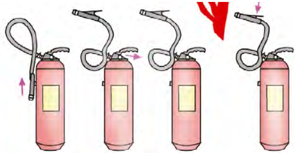
Sl.33. Postupak aktiviranja aparata za početno gašenje požara: 1. donjeti aparat na prihvatljivu udaljenost od požara, uhvatiti mlaznicu, 2. izvući osigurač, 3. usmjeriti mlaznicu prema požaru, 4. pritisnuti ručicu na aparatu i ručicu na mlaznici na crijevu (ukoliko je izvedena)
